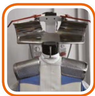
Dispositivo per lo stiro carrè. Device for yoke ironing.
