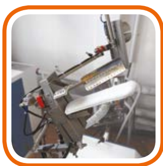
Pinze con chiusura ed espansione dei polsi/maniche corte, con automatismo per tensionamento e regolazione tendi manica. Adjustable and tensioning clamps with automatic closure of cuffs and sleeve.
