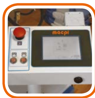
Programmatore dotato di Touch Screen 3,8" con 20 programmi memorizzabili e possibilità di impostare varie lingue. Mobile programmer equipped with a 3,8" touch screen with the possibility to set up 20 memorized programs and the possibility to set various languages.
