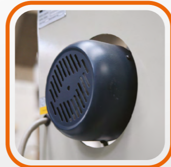
Motore per soffiaggio da 2 Hp 2 Hp motor for strong blowing
